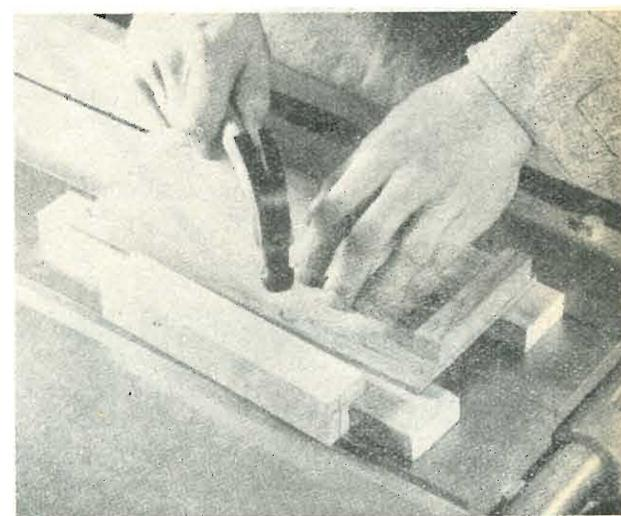
**12** Questa guida regolabile permette di ottenere parti con rastremature identiche. Ponete il pezzo nel fermo ad L, che è imperniato alla sua estremità anteriore. Allineate i segni della smussatura con il canale della guida per i tagli trasversali e fissate il fermo all'angolo desiderato con un chiodo. Quindi regolate la guida per i tagli longitudinali in
